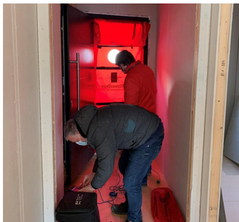
Figura 14. Ensayo Blower Door (Fuente: Medgón PassivHaus)
